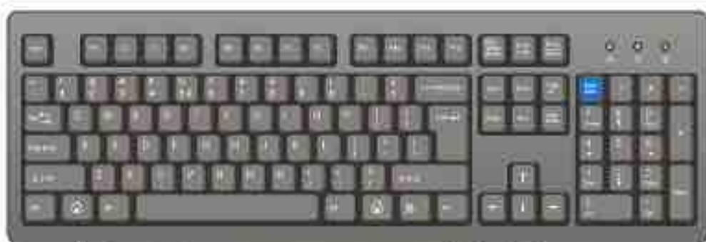
**ط. المفتاح Windows:** إن وظيفة هذا المفتاح عند استخدامه بمفرده هو فتح قائمة إبدأ Start أو إغلاقها إذا كانت مفتوحة، كما من الممكن استخدامه مع مفاتيح أخرى كثيرة في لوحة المفاتيح لتوسيع وظائف متعددة لمستخدمي نظام التشغيل، تغتيم عن استخدام الفارة.
