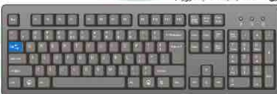
**ض- المفتاح Num Lock:** يرتبط عمل هذا المفتاح مع لوحة المفاتيح الرقمية الجانبية، فعندما تضغط على هذا المفتاح تصبح مفاتيح الأرقام نشطة، وعندما لا تضغط على هذا المفتاح تكون الأسهم والرموز الخاصة الموجودة أعلى الأرقام هي التي تستعمل.
