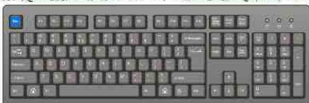
**حـ. المفتاح Insert:** ويختصر في بعض لوحة المفاتيح بـ Ins وبعد من المفاتيح التي تقوم بالوظيفة والوظيفة المضادة في الوقت نفسه. ويستخدم لحشر الحروف عند الكتابة في البرامج الطباعية أو عند إدخال البيانات (بالضغط على هذا المفتاح تنتقل بين نصتين من الكتابة، فالنقط الأول يظهر الكتابة قبل المؤشر الذي يدفع بالنص الذي يأتي بعده إلى اليسار. أما في النقط الثاني، فالنص الذي يكتب يعرض على التوالي أي نص موجود على يسار المؤشر).
